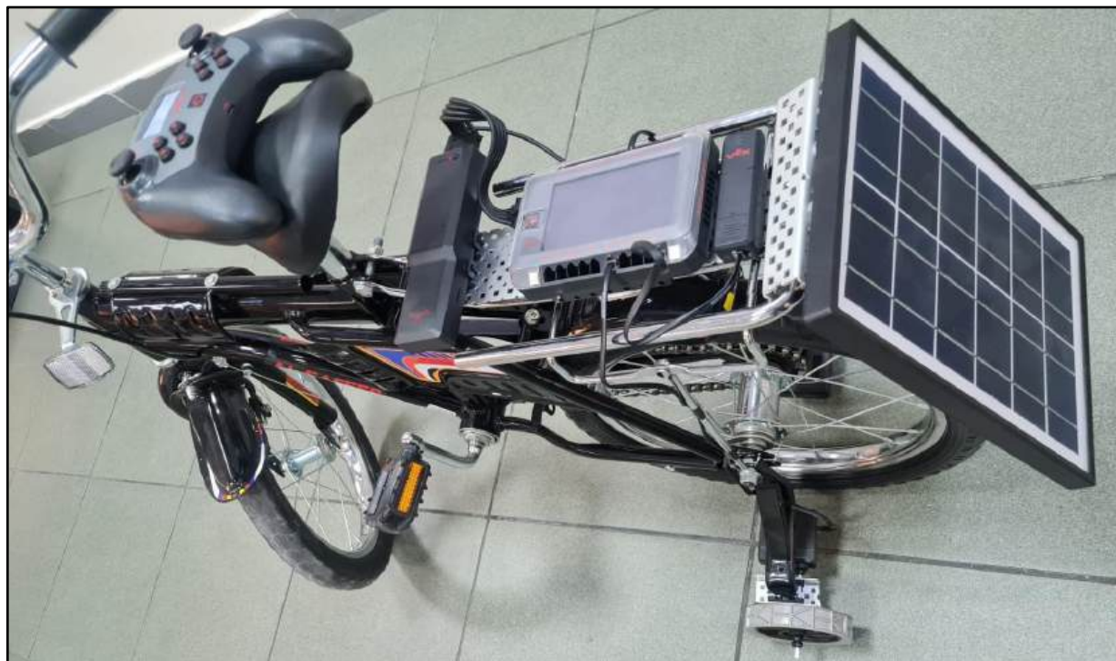
الشكل (9-2) صورة توضح التركيب الفعلي للدراجة الذكية بعد تثبيت الأنظمة والمكونات الإلكترونية عليها
