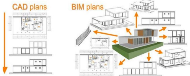
توحيد ودمج جميع أنواع المخططات، فمخطط التصميم Design يتطور و يصبح هو نفسه مخطط الرسومات التفصيلية Shop drawing و التي تتطور لتصبح مخطط التنفيذ As-built دون تعديلات كثيرة.
