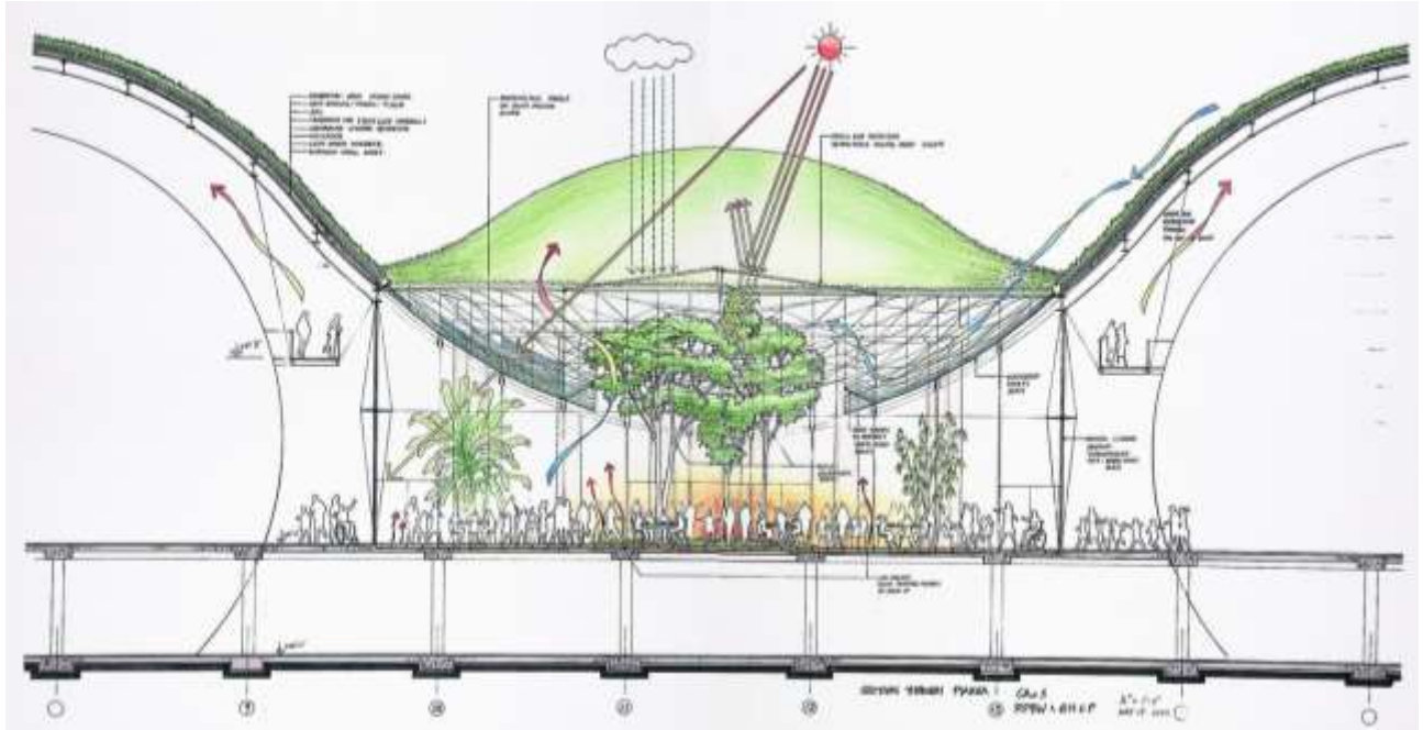
الشكل: (21) يوضح كيفية دخول التيارات الهوائية داخل المبنى
