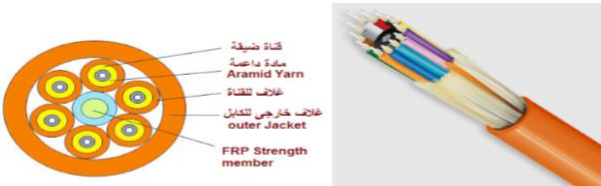
الشكل(2-9)- كابل الفايبر المجزئ Breakout fiber optic cable
