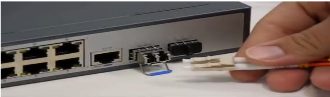
الشكل(3-15)- توصيل زوج من الليف الضوئي مع وحدة SFP
