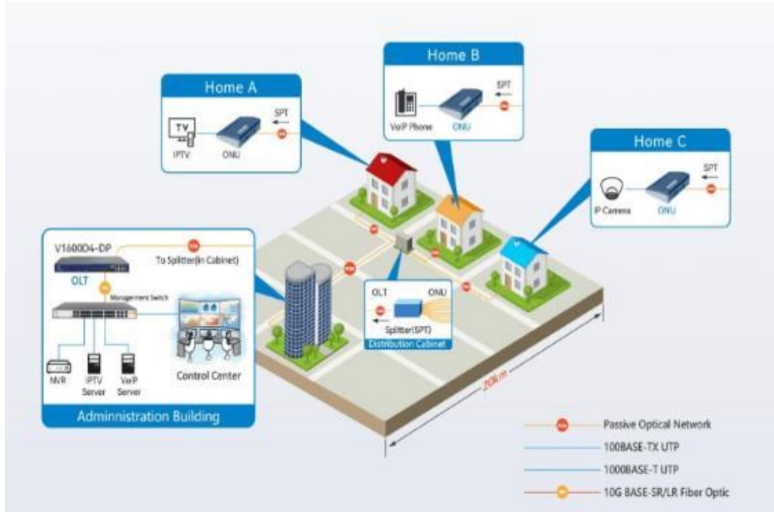
الشكل (2-34)- (الألياف إلى المنزل) لجهاز V-SOL EPON OLT V1600D4-DP
