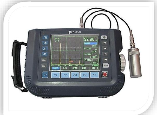
الشكل (15-2) جهاز قياس الاهتزازات الصوتية
