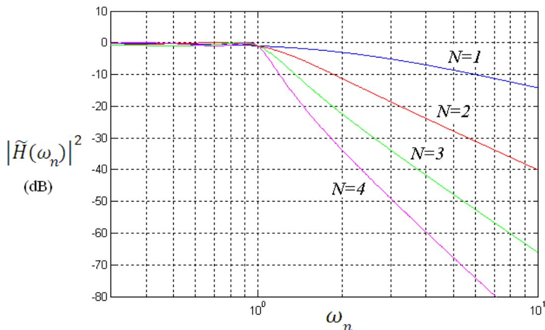
الشكل -Error! No text of specified style in document. 8: الاستجابة الترددية لمرشح شيببشيف ذو التمرير المنخفض من أجل قيم مختلفة لدرجة المرشح بالمقياس اللوغاريتمي.
