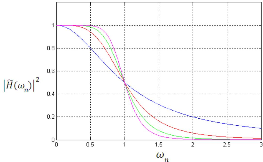
الشكل **Error! No text of specified style in document.** 4: الاستجابة الترددية لمرشح بترورث ذو التمرير المنخفض من أجل قيم مختلفة لدرجة المرشح بالمقياس الخطي.
