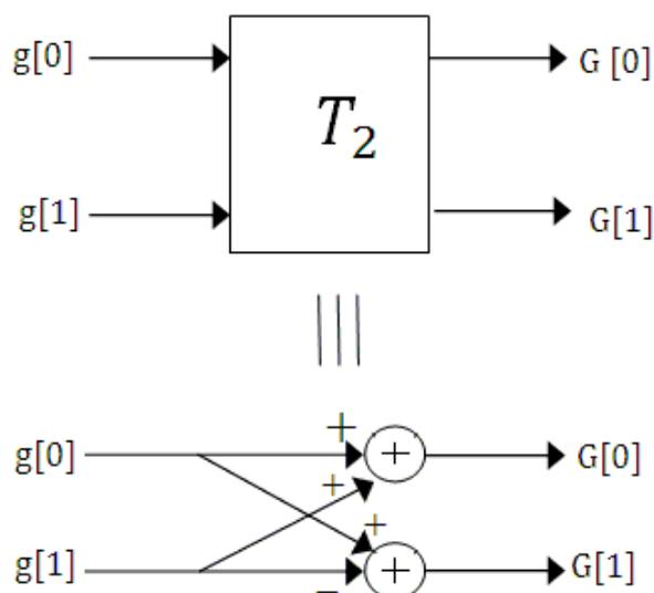
الشكل -Error! No text of specified style in document. 4: المخطط الصندوقي لعملية  $T_2$ .
