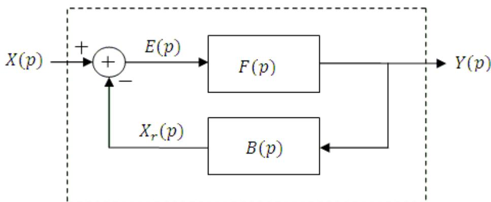
الشكل 3: نظام حلقة مغلقة. **Error! No text of specified style in document.**
