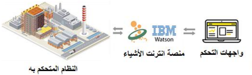
الشكل (1-3) الأجزاء الرئيسية لنظام إدارة و مراقبة معمل تعبئة الغاز المنزلي
