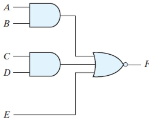
(b) باستخدام قانون دوموغان:  $F = \overline{(AB + CD + E)} = \overline{AB} \cdot \overline{CD} \cdot \overline{E}$
