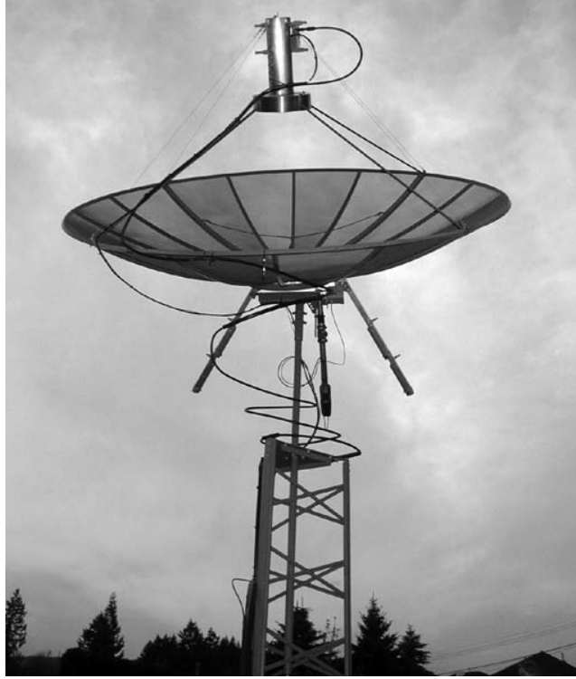
الشكل 3.6: هوائي قطعي 3 meters يعمل عند التردد 1296 MHz كهوائي EME.
