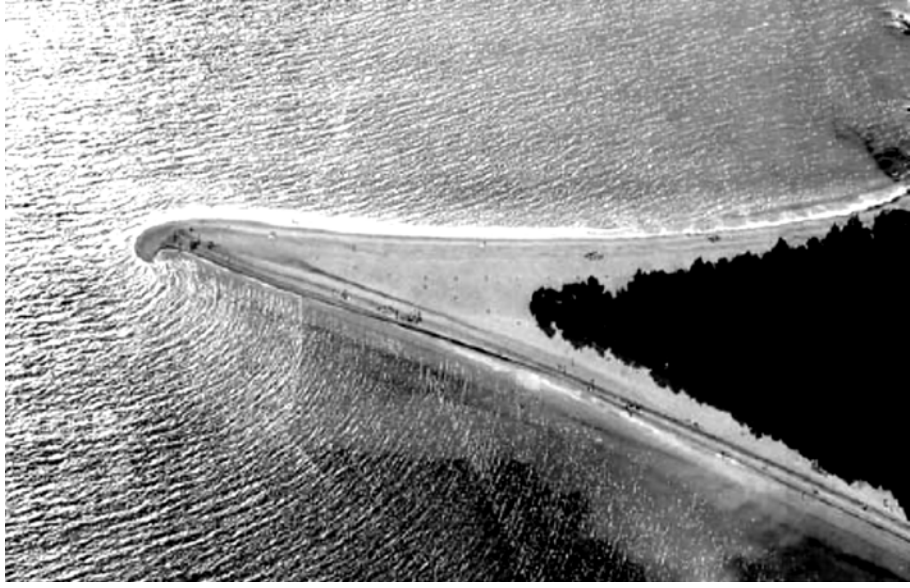
الشكل -12- انعراج حافة السكين Knife-edge diffraction لأمواج البحر
